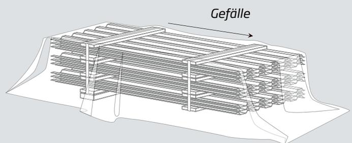
Verpackung: Abgedeckt auf Lagerhölzern. Bitte beachten Sie, dass eine gute Ventilation unter der Abdeckung sehr wichtig ist.
