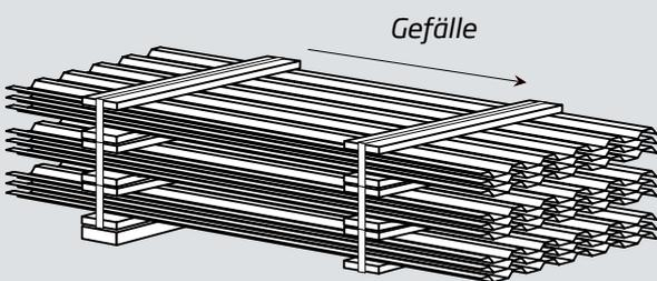
Die Bleche müssen etwas schräg auf Lagerhölzern gelagert werden, damit sie nicht gedrückt werden und Wasser ablaufen kann. Die Bleche müssen so abgedeckt sein, dass eine gute Luftzirkulation möglich ist.
