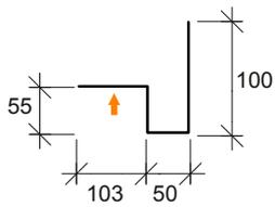
DS Seitlicher Fassadenabschluss 3-696
